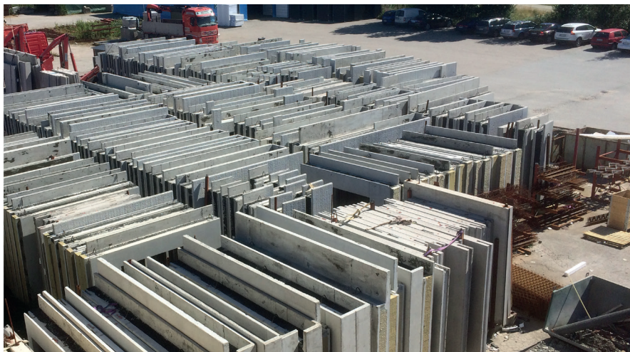
Väggelementen från Lättklinkerbetong står klara i väntan på att levereras ut till respektive projekt.
