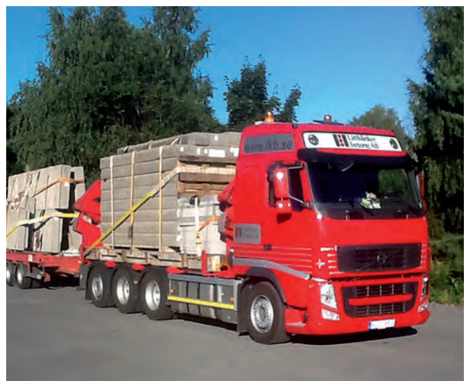
Volvo FH 500HP 84 RIGID TRIDEM med specialanpassad påbyggd SIMA-lift.
